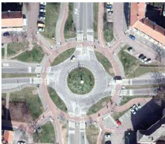
Giratoire Bois-le-Duc, piste bidirectionnelle prioritaire hors du giratoire (source : Conférence Vélo Suisse)
